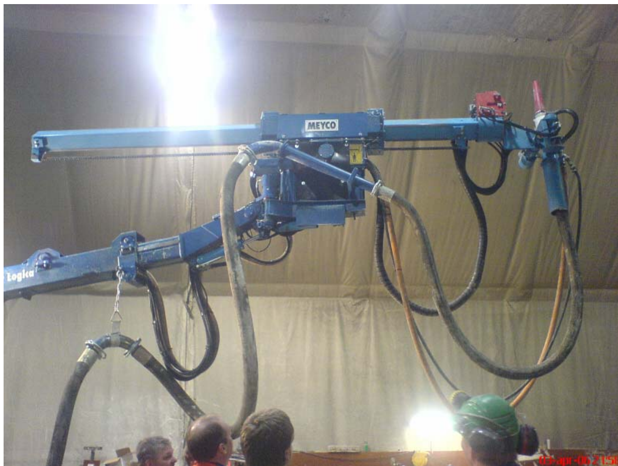
Figur 1. Detalj av robotarm på Meyco Logica. Scanningutrustningen är placerad strax till vänster om sprutmunstycket i bildens högra del.
